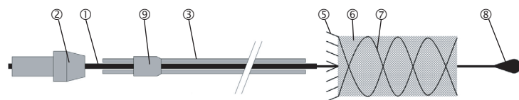
Fig. 2: Sistem de administrare detașat și implant p64 desfășurat
