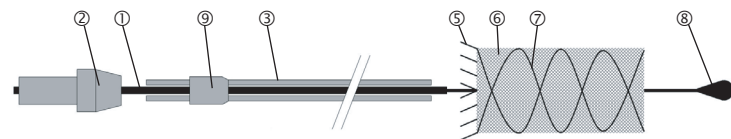
Abb. 2: Abgelöstes Einführsystem und entfaltetes p64-Implantat
