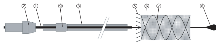
2 pav. Atjungiamą įdėjimo sistema ir išskleidžiamas p64 implantas
